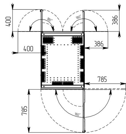
Угол открытия дверей при установке шкафов в ряд составляет 155°.
