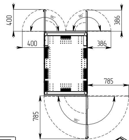
Угол открытия дверей при установке шкафов в ряд составляет 155°.
